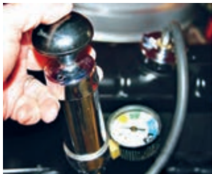
شکل ۶. آزمایش نشت یابی تحت فشار
