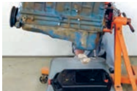
شکل ۳۳. موتور نصب شده روی استند
