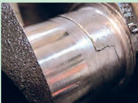
شکل ۶۵. میل لنگ شکسته
