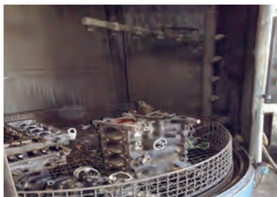
شکل ۶۱. شستشوی موتور به وسیله دستگاه شات بالاست
