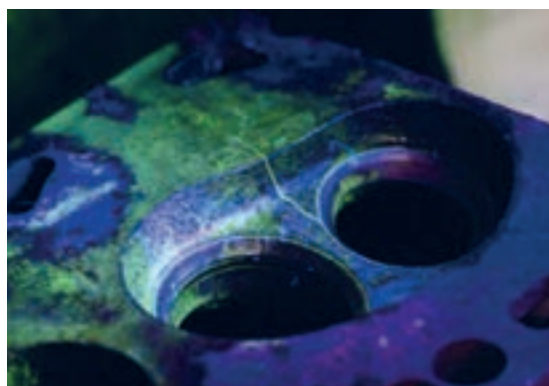
شکل ۶۶. ترک خوردگی سرسیلندر در محفظه احتراق
