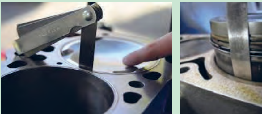
شکل ۷۷. اندازه گیری لقی پیستون در سیلندر با فیلر
