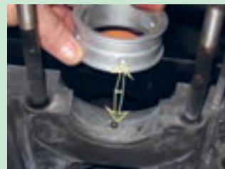
شکل ۹۳. قرار گرفتن سوراخ روغن مقابل هم
