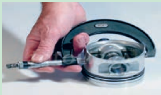
شکل ۷۵. اندازه‌گیری قطر پیستون با میکرو متر
