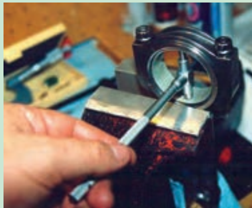
شکل ۸۳. کنترل بیضی شدن سر بزرگ شاتون
