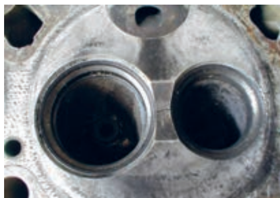
شکل ۶۶. ترک خوردگی سرسیلندر در محفظه احتراق
