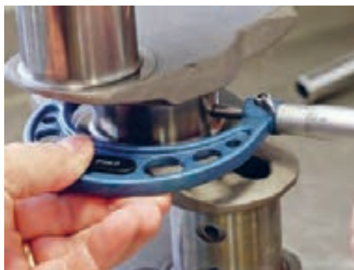
شکل ۷۱. اندازه‌گیری قطر میل لنگ
