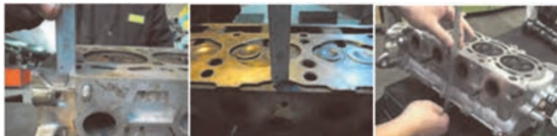
شکل ۸۳. کنترل ارتفاع مجاز کف تراشی سر سیلندر
