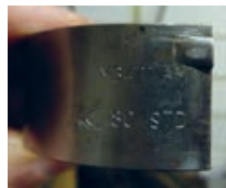
شکل ۲۳. تغییر ضخامت یاتاقان در سایزهای مختلف
