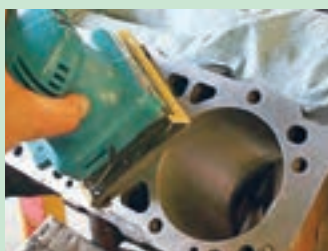
شکل ۶۶. تمیز کردن سطح بلوکه سیلندر با سنباده زن دستی و الکتریکی
