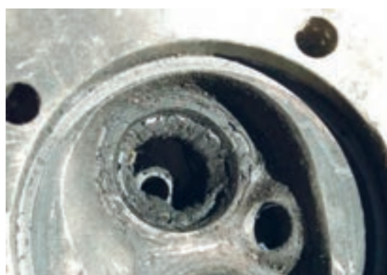
شکل ۶۷. کربن گرفتگی سرسیلندر و سوپاپ‌ها
