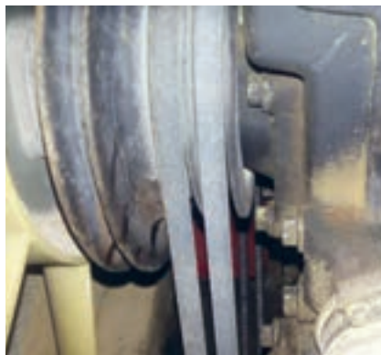
شکل ۷. استفاده از دو تسمه در تراکتور MF۳۹۹
